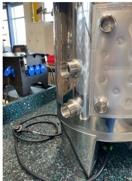
Abbildung 2: Zwei Ein-Zoll-Einschraubstutzen für Drucksensoren
