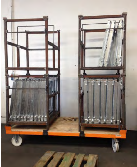
Abbildung 8: Routenzugwagen mit Kopf- & Bodenrahmengestell
