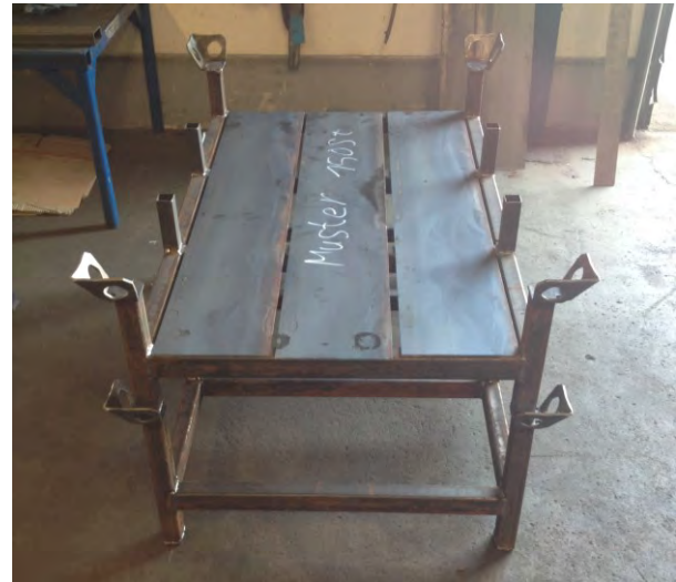
Abbildung 10: flaches Rungengestell für Bauteile
