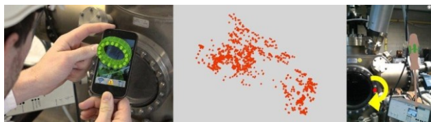
Abbildung 2: AR-Anwendung: Illustration (links), Tracking-3D-Punktwolke (Mitte) und virtuelle Überlagerung (rechts)
