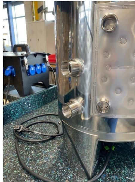
*Abbildung 2: Zwei Ein-Zoll-Einschraubstutzen für Drucksensoren*
