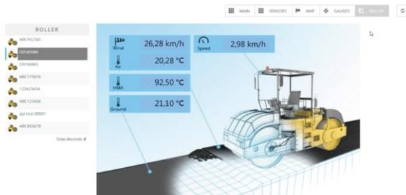
Abbildung 2: Mit dem „Digitalen Zwilling“ können die Konstrukteure ihre Produkte ohne großen Aufwand direkt in der IoT-Software testen.
