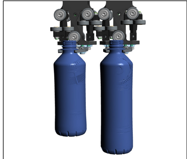
Abbildung 2: Zeichnung von Behältern in zwei Größen (0,33l und 0,44l) am Transport-Shuttle
