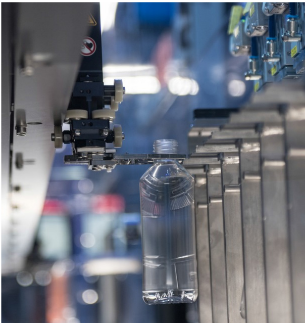
Abbildung 7: Transportsystem mit 1:1 Verknüpfung zwischen Shuttle und Flasche
