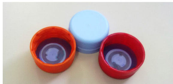
Abbildung 8: RFID im Verschluss zur Produktverfolgung
